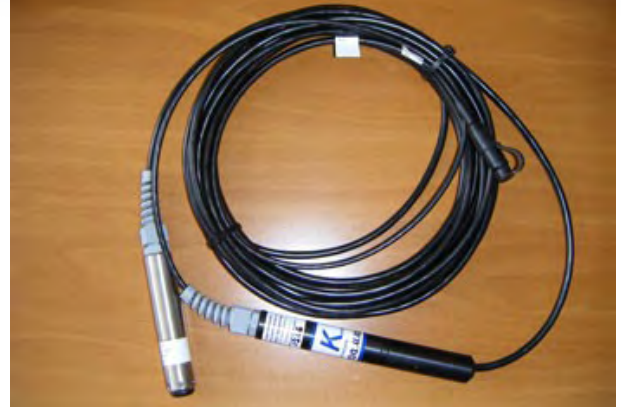
A vízállás és a talajvízszint mérésére használt nyomásmérő szonda (Forrás: NYUDUVIZIG)
