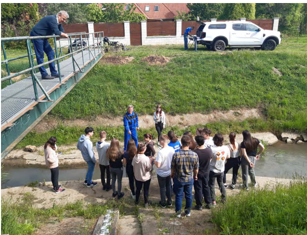
1. ábra: A diákok a forgószárnyas vízsebességmérő műszeres vízhozamméréssel ismerkednek Szombathely-Oladon
