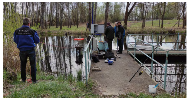
Mozgóhajós ADCP műszerrel történő vízhozammérés (Forrás: NYUDUVIZIG)
