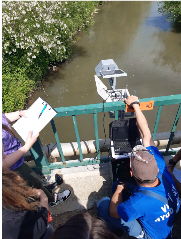
2. ábra: A diákok a radaros vízszint érzékelőt tanulmányozzák Vaskeresztesen
