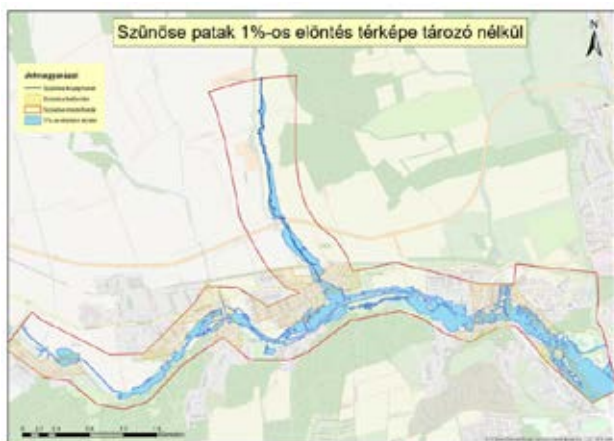
6. sz. ábra: Szünöse-patak 1%-os előntés térképe tározó nélkül (Forrás: Megvalósíthatósági tanulmány)
