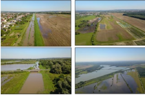
21. ábra: Drónos repülés a Principális-csatorna alsó és felső szakaszán az árhullám levonulásának és elöntések kiterjedésének meghatározása céljából (Forrás: Simon Zoltán KÜM, NYUDUVIZIG)
