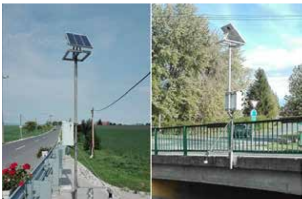
6. ábra Új radaros távmérő állomások az Arany-patakon (Dozmat, Bucsu)
