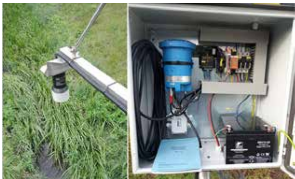
7. ábra Német gyártmányú radaros szintmérő és adatgyűjtő
