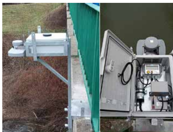
8. ábra Radar szenzoros távmérők a Rába folyón
