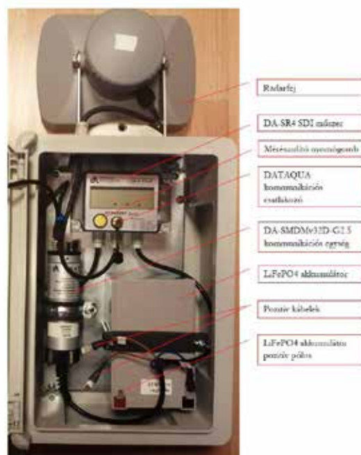
9. ábra DA SDI-RLS radar szenzoros távmérő berendezés
