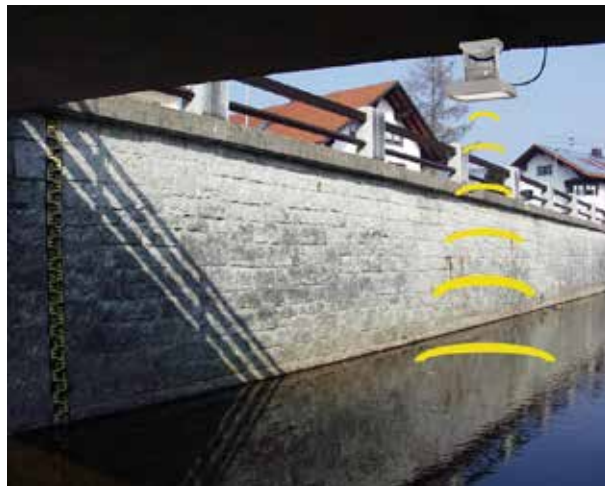
4. ábra Hídra szerelt radar szenzor.
