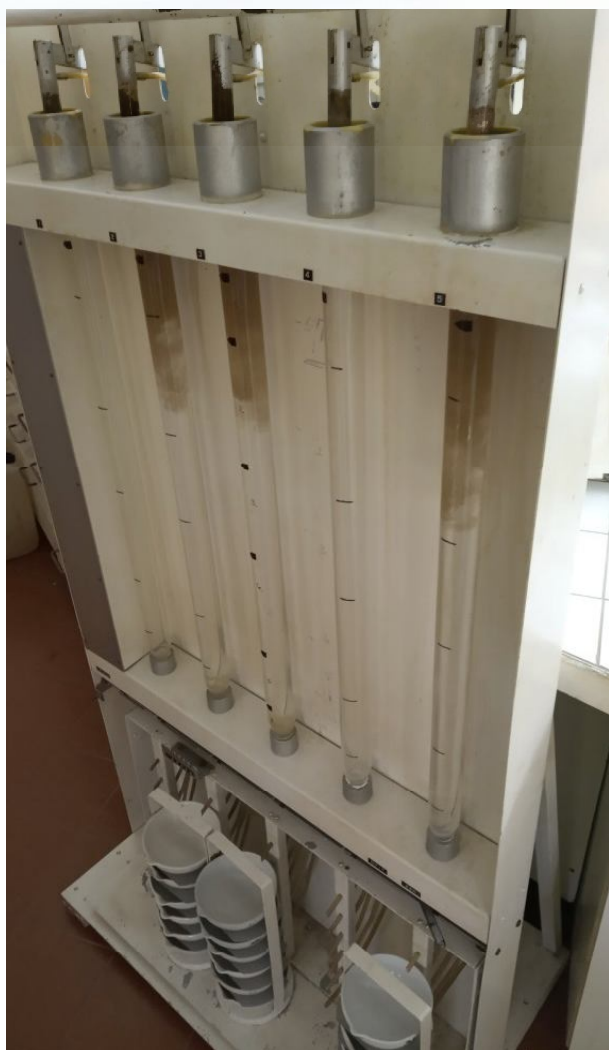
1. kép: Az ülepítő berendezés a minták betöltése után (Batki, 2019)
