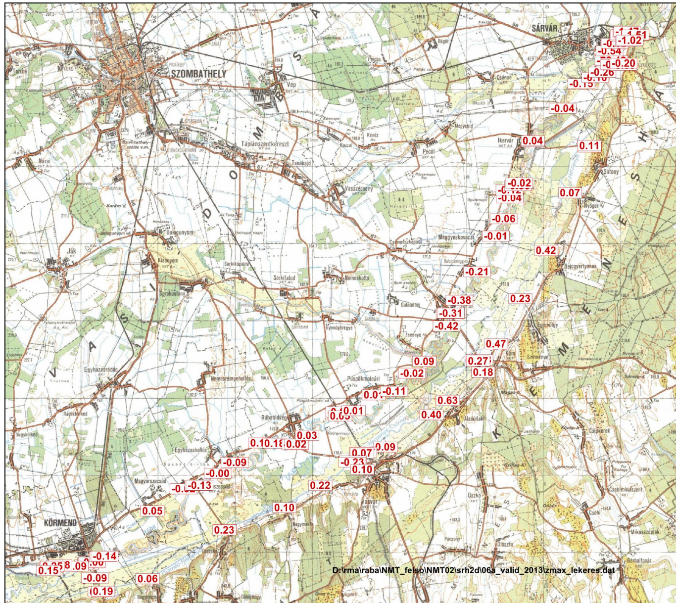
18. ábra: A 2013. februári árhullámra számított és mért tetőző vízszintek közötti eltérések [m]
